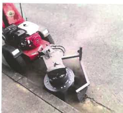
Acquisition d'un porte-outil autotractable avec brosse de désherbage et herse désherbante (pour les surfaces en gravier)
